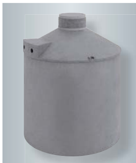
Eisspeicherbehälter mit 10 m 3 Wassergehalt. Das Wasser dient als Speichermedium und wird im Bedarfsfall kontrolliert vereist.
