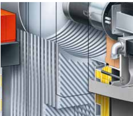
Inox-Crossal-Wärmetauscherfläche für hochwirksame Wärmeübertragung und Kondensationsrate
